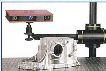
2020年7月導入の高精度3Dスキャナーにより、部品の全体形状を高密度な点群データやポリゴンメッシュデータとして取得して、測定対象物の表面状態と形状を正確に再現します。
